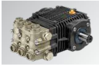
Nueva bomba CL 6.0 autocebante de tres pistones de cerámica integral, rodamientos de rodillos cónicos, doble visor de aceite, cabezal de latón niquelado y juntas de agua para altas temperaturas
